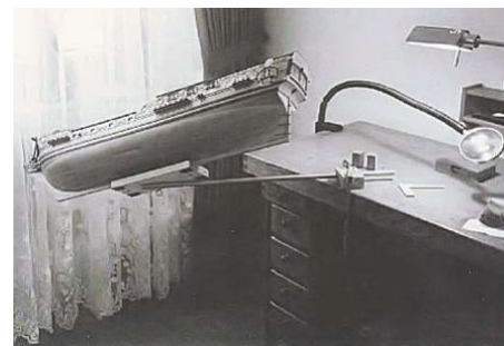
Abb. 01: Der Stabmanipulator im Einsatz.
