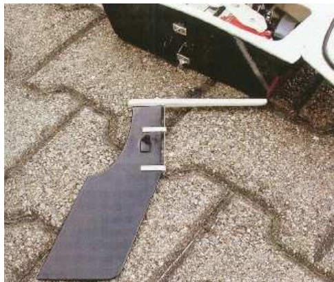
Abb. 7: Das Ruder läßt sich für den Transport aushängen
