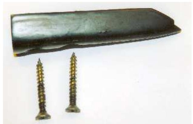
**Bild 6.16:** Ein Stützlager aus Vollmessing. Bei der Anfertigung müssen zuerst die zwei ebenen Flächen rechtwinklig bearbeitet und alle Löcher fertig gebohrt werden. Dann schraubt man den zu dem Zeitpunkt noch eckigen Rohling auf eine schmale Leiste oder auf ein Aluprofil. Diese Leiste dient bei der Bearbeitung der gewölbten Außenfläche als Griff bzw. als Einspannfahne im Schraubstock.
