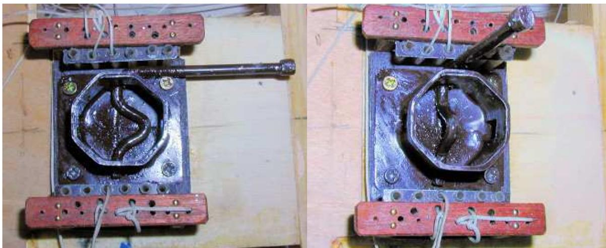
Auf dem linken Bild ist der Knebel, gefertigt aus einem Nagel (3,8 x 100 mm) vom Baumarkt in liegender Position, rechts in der hochgestellten Position.
