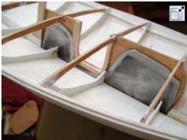
Lücke in Schwert und -Kasten für den Ballast
