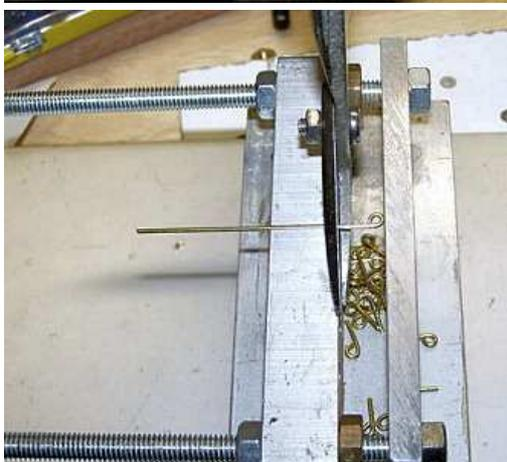
hier wird der Draht auf Länge gebracht
