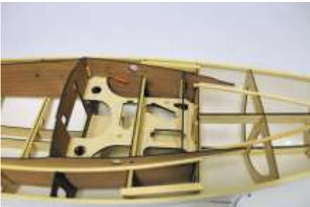
Bild 4: Die RC-Brettchen sind so gemacht, dass sie sich gegenseitig sichern. Dadurch müssen nur zwei Schrauben gelöst werden, wenn die Fernsteuerung ausgebaut werden soll.
