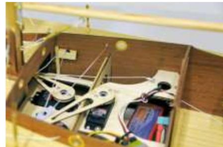
Bei meiner Hansa-Jolle stieß der Hebelarm des Großschotenservos an zwei Spanten und der Kajütvorderwand an. Hier musste ich etwas nacharbeiten. Als Akku verwende ich gerne einen 2-zelligen LiPo – Akku mit 2100mAh Kapazität. Viele RC-Anlagen vertragen heute schon die 7,4V dieser Akkus. Ich verwende für meine alten Komponenten aber immer einen 5V Spannungsregler. Der Akku ist sehr leicht und hat genügend Kapazität für einen ganzen Segeltag.
