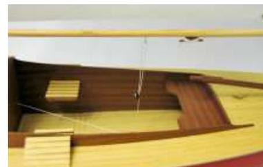
Bild 13: Die Großschot ist nur in die Öse am Baum eingehängt und über den Klemmschieber in der Länge verstellbar.
