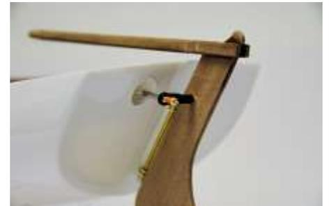
Bild 6: Die Ruderanlenkung ist zwar nicht gerade eine Zier, aber funktional, solide und einfach zu warten.
