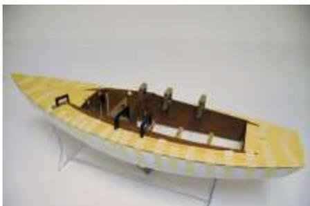
Bild 7: Mit viel Klebeband und ein paar Schraubzwingen wird das Deck in einem Stück montiert.
