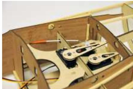
Bild 5: Hier sind die Servos schon eingebaut. Alles wirkt sehr aufgeräumt.
