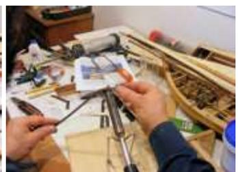
Anschließend Polyurethan drauf und spannen, was in diesem Bereich immer ein Abenteuer ist. Wenn es getrocknet ist, Kanten sauber machen und die nächste Planke. So wächst der Rumpf langsam zu.
