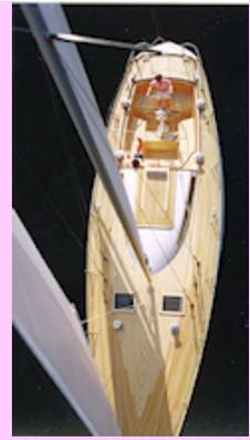
Bild 1.8: Diese "Smaragd" wurde optisch mit einem individuellen Holzdeck und reichhaltiger Detaillierung aufgewertet, die Leichtwindeigenschaften wurden durch den Einsatz einer optimierten Genuasteuerung gegenüber der Basisausführung um ein ganzes Stück verbessert. So lässt sich auch aus einem Bausatz ein hochwertiges vorbildähnliches Modell erstellen.
