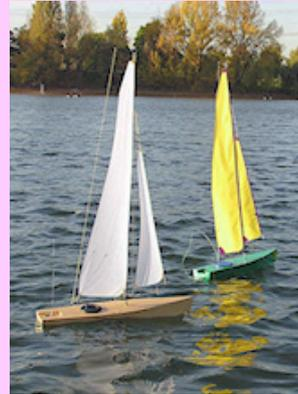
Bild 1.9: Die "Basic-Jolle" gebaut von Ralph Tacke nach dem Bauplan des Modellbauclubs Rodenkirchen. Sie ist zwar ein reines Zweckmodell, dafür segelt sie aber hervorragend und ist auch für den Eigenbau durch Kinder geeignet. Der Bauplan mit ausführlicher Baubeschreibung und Baustufenfotos steht als Freeware auf der Webseite des Vereins ([www.modellbau-rodenkirchen.de](http://www.modellbau-rodenkirchen.de)) zum Download zur Verfügung.
