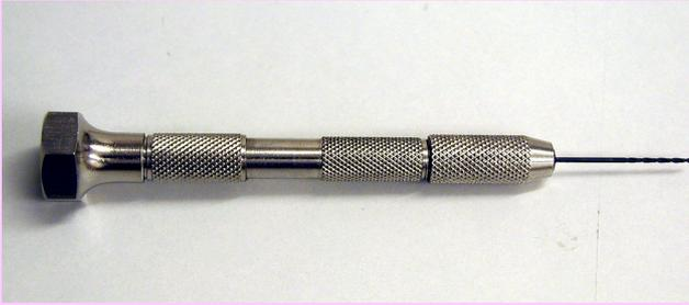
**Bild 1.15:** Das Stiftenklöbchen ist ein Präzisionswerkzeug zum Bohren kleiner und kleinster Löcher, wenn man eine Bohrmaschine nicht einsetzen kann oder möchte. Es leistet wertvolle Hilfe, wenn "mal eben" ein kleines Loch an schwer zugänglicher Stellen gebohrt werden muß. Auch kleine Gewindebohrer oder Reibahlen können im Stiftenklöbchen eingespannt werden.
