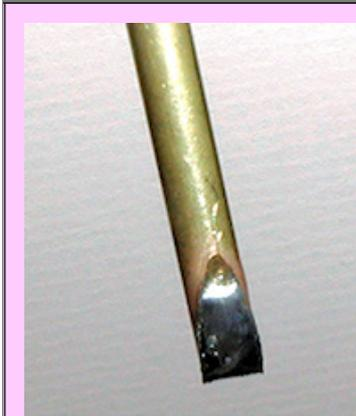
Bild 1.17: Um eine gute Verbindung zwischen zwei zu verlötenden teilen zu schaffen und den Lötvorgang zu vereinfachen, wird zunächst ein großer Tropfen Lötzinn auf die Feilstelle an der Strebe aufgebracht, wobei gleich der obere Teil des Messingröhrchens mit Zinn gefüllt wird.
