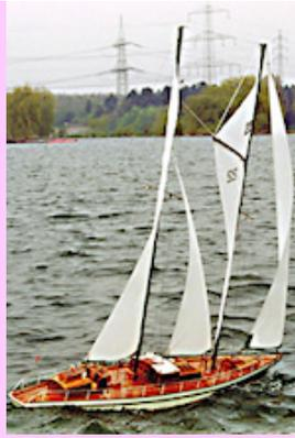
Bild 1.6: Mit der "Atlantis" von robbe erhält man einen attraktiven Zweimaster mit Spreizgaffelrigg, der sich bereits im Grundsatz durch eine gute Detaillierung auszeichnet, die sich jedoch durchaus weiter verfeinern lässt. Für leichten Wind kann man die "Atlantis" auch mit einer Genuasteuerung ausrüsten.
