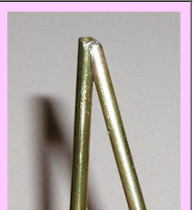
Bild 1.18: Zum Abschluß der Lötarbeiten werden eventuelle Grate und zu dicke Lötunkte abgefeilt und geschliffen. Anschließend ist die Nahtstelle (bis auf das helle Lötzinn) nicht mehr sichtbar, und nach dem Lackieren sieht das Werkstück wie aus einem Guß aus.
