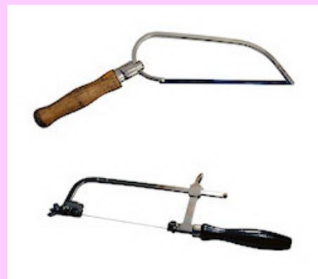
**Bild 1.14:** Eine kleine Puksäge (oben) eignet sich sehr gut für Sägearbeiten an Holz, Kunststoffen oder Metallen. Wenn noch feiner gesägt werden soll, ist eine Juweliersäge (unten) besser geeignet als eine herkömmliche Laubsäge. Sie hat einen verstellbaren Bügel und eine feinfühlige
