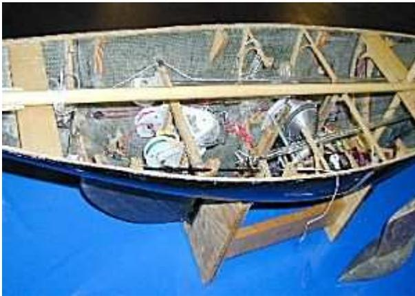
Deutlich zu erkennen die Aufteilung der zwei Aluminiumkegel der Vorsegelwinde.
