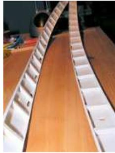
Die eingesetzten Schanzkleidstützen
