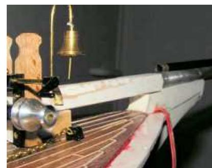
Weiter geht es mit den Schanzkleidern, die aus zwei langen ABS-Teilen bestehen und zunächst mit den Schanzkleidstützen versehen und lackiert werden müssen.
