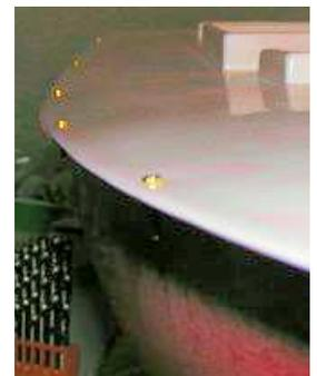
Nun wird das Deck angepasst und gemäß Anleitung verschraubt. Um ein Verziehen während des Verschraubens zu vermeiden, sollten Mittenmarkierungen an Rumpf und Deck angebracht und mit einer Klammer fixiert werden. Die für das Verschrauben zu setzenden Bohrungen sollten im Abstand von etwa 3mm vom Rand entfernt angebracht werden, setzt man sie weiter mittig, müssen sie später zugespachtelt werden (eigene leidvolle Erfahrung ;-)
