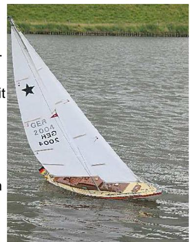
Die Segel aus leichtem Dacrongewebe (120 g/m<sup>2</sup>) sind an Vor- und Unterliek beidseitig mit einem 12 mm breiten Tapestreifen verstärkt. In den Kopf, Hals und das Schothorn sind Ösen eingestanz, Ringe aus Messingdraht halten das Vorliek des Großsegels am Mast.
