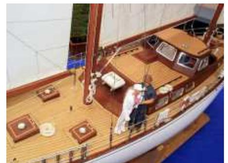
dem Holzklotz aufgezeichnet und immer wenn ein Loch gebohrt war, wurde der spätere Lüfter um einen Teilstrich verdreht. Trotz aller Sorgfalt bei der Ausrichtung ergaben sich doch einige Unregelmäßigkeiten und um die benötigten 4 Lüfter in einer brauchbaren Qualität zu erhalten mußten 6 Stuhlnägel "gelöchert" werden. Abschließend war nur noch der Nagel zu kürzen, dann konnten die neuen Lüfter auf den Lukendeckeln festgeklebt werden.
