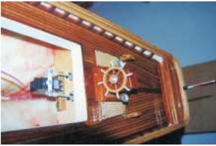
Unter dem Steuerstand (eigene Herstellung) liegt die Rudermaschine.
