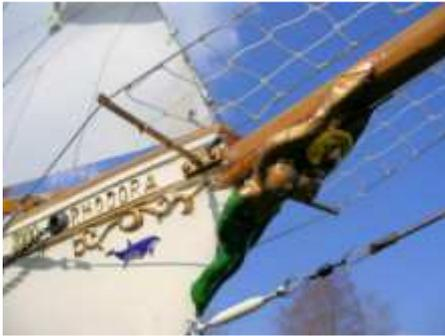
Ein "Oldtimer" braucht eine Galionsfigur. Gesagt getan, mir kam die Idee die Figur aus Knetmasse zu modellieren. Anschließend tauchte ich "Sie" in GfK-Harz. Nach dem Trocknen wurde sie bemalt. Sieht sehr "fraulich" aus..
