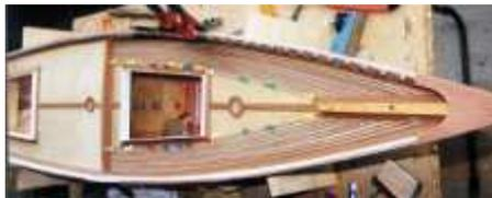
Planke für Planke wird mit UHU-hart aufgeleimt. Nebenzu werden die Spanten an das Schanzkleid angeleimt wo später die Schanzabdeckung drauf geleimt wird.
