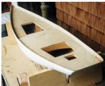
Die Aufbauten eines Neufundland-schoners paßten jetzt auch nicht mehr zu dem Stagesegelrigg. Also kam in die Mitte des Schiffes eine zweite Kajüte. Das hatte auch den Vorteil, daß eine zweite Öffnung entstand, durch die später die zwei Segelwinden plaziert wurden.
