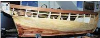
Schön zu sehen, jede einzelne Planke wird mit Zug und Druck befestigt. Als Leim kommt UHU-hart zum Einsatz
