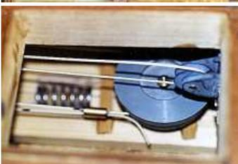
Umlaufschot mit Vorspannung
