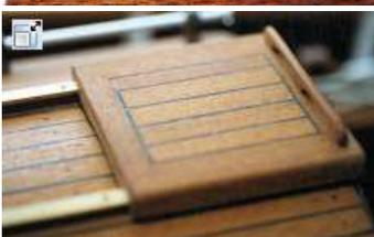
Das Deck besteht aus 3mm starken Teakholzmaterial, welches ich aus 4 Tischbeinen eines Eßzimmertisches sägte. Dieser war über 30 Jahre alt, also gut gelagert und gewiß kein Plantagenholz. Die Fugen sind aus schwarzem Epoxydharz. Und zum Schluß dann alles schleifen und mehrfach ölen. Die Schanzabdeckung ist aus Massiveichenholz, Sonne und Wasser bleiben so außen vor!
