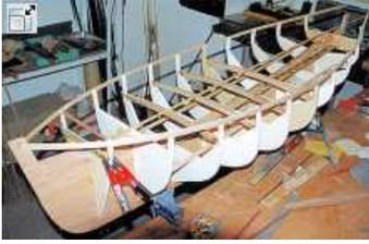
Das Spantgerippe ist fertig verleimt
