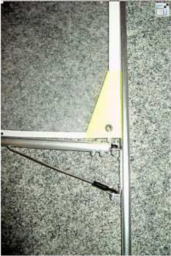
Bild 6 Das Groß ist so nicht segelfähig, die Aufhängung erfolgt mit Kugelköpfen auch beim Niederholer
