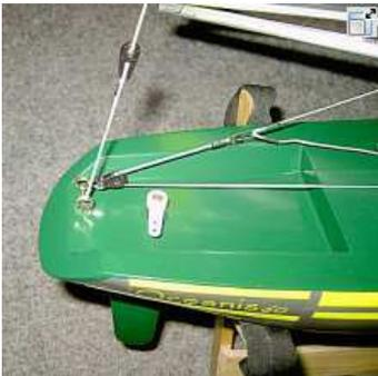
Bild 7 das neue Heck mit Umlenckblock, die Durchführungen für Schot und Ruder im Rumpf fehlen noch
