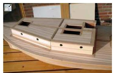
Darauf wurden dann von außen abwechselnd 10mm und 5mm breite Kiefernleisten als Bordwand verklebt. Für die Rundungen im Heckbereich mußten die Leisten weich gekocht werden. Der Abschluß des Bords bildet eine 15mm breite Kiefernleiste, die ansprechend den Handläufen abgerundet wurde und anschließend dunkel gebeizt wurde. Der äußere seitliche Abschluß des Decks bildet eine komplett umlaufende 5mm dicke Halbrund-Messingleiste als so genannte Scheuerleiste.
