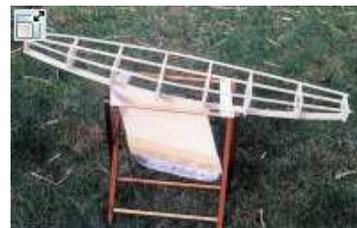
Nach dem Bau des Gerippes legte ich das Boot auf seinem Hellingbrett unter die Ständerbohrmaschine und bohrte die Löcher für Mast und Ruderkoher. Das sichert den absolut senkrechten Sitz von Mast und Ruder, was für die Manövrierfähigkeit des Bootes von entscheidender Bedeutung ist. Bei Karl Koffend steht der Mast auf einer Schiene und wird nur von Wanten gehalten; man kann ihn dann verschieben, aber einstecken ist schneller, sicherer und leichter in der Handhabung.
