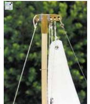
Wegen des Transports und der Anpassung an die verschiedenen Segelstellungen ersetzte ich das allerdings durch Mastringe aus Messing. Die verschiedenen Wanten und Stage bestehen aus Seil aus dem Drachengeschäft, und Beschläge wie Ringösen, Stagschienen usw. findet man heute in den Katalogen der Modellbaufirmen. Die Lackierung ist aus den Fotos zu ersehen. Die Namensschilder wurden von einem Schlüssel- und Schilder-Schnelldienst (Mister Minit) gefertigt.
