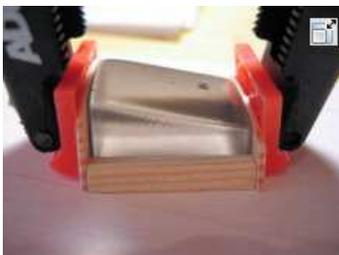
Abb. 6 (3): Der Kunststoff ist an den Klebeflächen aufgeraut und mit Waschbenzin fettfrei gemacht. Beim Aufrauen sollte man vorsichtig vorgehen, um die Fensterflächen nicht versehentlich zu zerkratzen. Geklebt habe ich diese Verbindungen mit UHU-Hart. Hier entsteht der Lichtschacht vorne.
