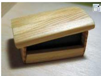
Abb. 7 (3): Fertig. Verschliffen und mit Holzwachs behandelt, kann der Lichtschacht auf Deck verklebt werden.
