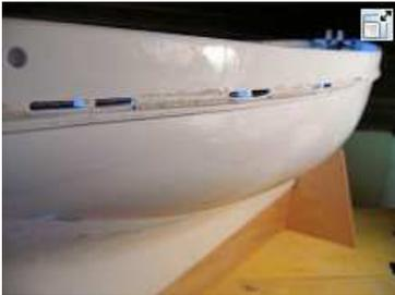
Abb. 4 (4): Hier hat der Hauck geschludert... zwischen den Kleberändern ist ein Spalt entstanden, den ich jetzt -selbst gemachte Leid- mühsam überarbeiten muss. Erkennbar ist die Schlamperei an der grauen Spachtelmasse, übrigens die von Revell. Die ist gebrauchsfertig aus der Tube und super zu verarbeiten.
