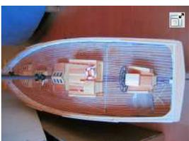
Abb. 5 (5): Die fertige Holzverschanzung. Zum Herstellen des Ankerbalkens folgt noch ein kleiner Abschnitt... Die runden Handläufe sind angefertigt und vorläufig eingesteckt.
