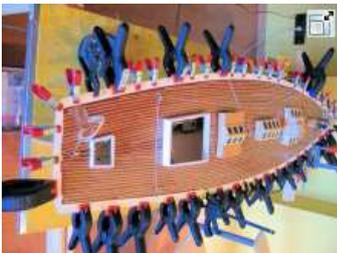
Abb.: 1 (4): Die empfohlene Anzahl von mindestens 30 Klammern ist nicht untertrieben. Wir haben, glaube ich, mehr benutzt. Viel hilft viel! Mit dem relativ teuren Kleber haben wir auch nicht gespart. Das Lösen der Messingschrauben nach Aushärten des Klebers war auch ohne Zuhilfenahme eines Lötkolbens möglich. Nu isses zu spät für Korrekturen an der Technik unter Deck, es pappt atombombensicher auf dem Rumpf...
