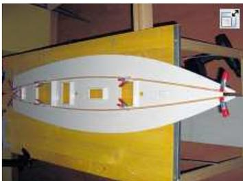
Abb. 1 (2): Die mit Klammern fixierten Hilfsleisten auf dem Deck zur Anzeichnung der ersten Markierungen. Zwischen den Leisten und der letzten Luke (achtern) sind Leistenstücke mit einer Breite von 6 mm einzuklemmen. Beide Leisten unbedingt symmetrisch ausrichten!
