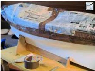
Abb. 1 (5): Das Unterwasserschiff fertig zum Lackieren. Vorher habe ich den gesamten Rumpf mit Haftgrund vorbereitet und fein geschliffen. Keine gute Idee: das Paketklebeband.
