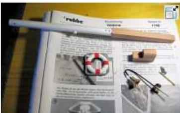
Abb.: 6 (4): Gut zu erkennen: das dicke Ende der Einnietmutter 11.7 im Bugspriet aus Aluminium. Es wird bei Befestigung der Einheit am Vordersteven in der Bohrung im Vordersteven verschwinden und zusätzlich für Führung sorgen. Ich habe mich entschieden, das Bugsprietteil 11.4 und den Unterlegklotz 11.5 mit Holzwachs zu behandeln. Der Rettungsring ist dreifarbig, das Gestänge der Schiffsglocke mattschwarz lackiert.
