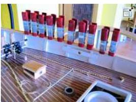
Abb. 4 (5): Das Ankleben der Laufleisten. Der graue Belag auf dem Deck ist Schleifstaub.
