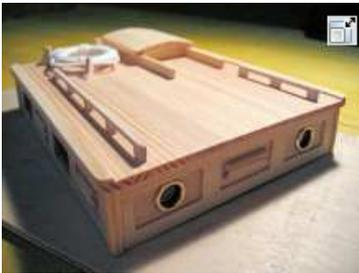
Abb. 9 (3): Die Kajüte ist noch nicht fertig verschliffen und noch nicht mit Holzwachs behandelt. Die Handläufe und Befestigungen für den Rettungsring sind sehr sauber ausgeschnitten. Die Messingbullaugen sind auf 1,8 mm herunterzuschleifen. Die von Robbe vorgeschlagene Vorgehensweise mit einem abgeschnittenen Klebstoffhütchen ist bestimmt zielführend, aber zu kompliziert: 100er Schleifpapier und eine ebene Arbeitsunterlage erfüllen auch den Zweck.
