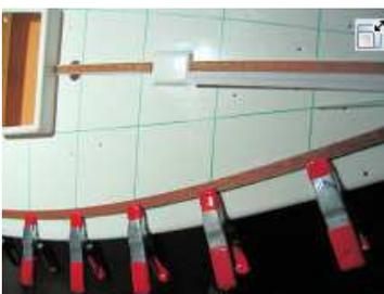
Abb. 3 (2): Die mittlere Königsplanke mit Kalfaterstreifen ist aufgeklebt. Wie von Robbe vorgeschlagen, habe ich die äußere Königsplanke nur von außen an der Hilfslinie entlang mit Sekundenkleber angeheftet.
