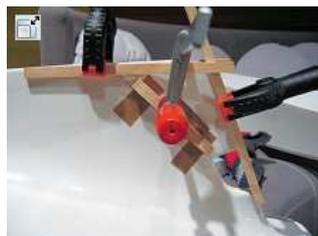
Abb. 1 (1): Paketklebeband verhindert ein Verkleben der Hilfsleisten mit dem Kunststoff.
