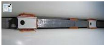
Abb. 10 (1): Die fertig ausgerichteteten, verklebten und mit den Verstärkungen versehenen Mastsockel.
