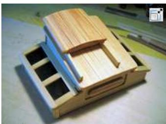
Abb. 8 (3): Der vordere Niedergang. Alle Fensterflächen werden mit Holzwachs behandelt, das verleiht ihnen eine matte, dennoch transparente Wirkung.
