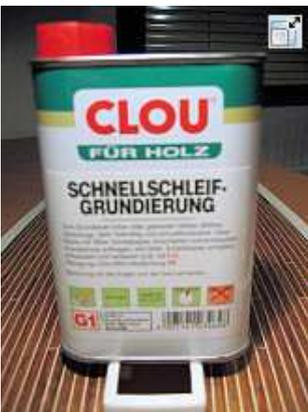
Abb. 13 (2): Vor der ersten Lackierung mit Bootslack habe ich das Deck zwei Mal mit diesem Porenfüller gestrichen und dazwischen fein geschliffen. Das Resultat ist eine gleichmäßig glatte Oberfläche des Holzes.
