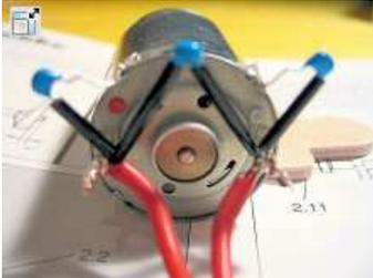
Abb. 7 (1): Der Motor mit Kondensatoren, Stromkabeln (rot) und Isolierschläuchen.
