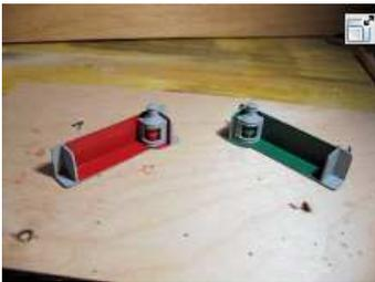
Abb. 7 (6): Die Positionslichter mit den Lampenborden auf einem Baubrettchen vor dem Einbau in die achteren Wanten.
