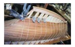
Im Bereich der Kielleiste werden die überstehenden Leisten plangeschliffen, um an die gegenüber liegende Leiste angepasst zu werden. Im Bereich des Übergangs Hecksrundung zur Kielflosse musste ein kleiner Keil eingearbeitet werden, weil die Leisten nur eine bestimmte Elastizität haben. Nachdem man den ganzen Rumpf so beplankt hat, kann man stolz auf seine bisherige Arbeit sein, und man kann schon etwas vorzeigen.
