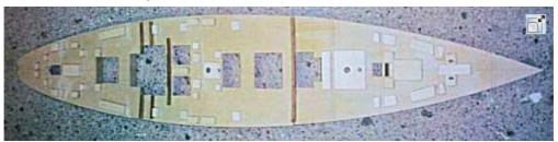
Jetzt war genügend Platz, um Arbeiten im Rumpfinneren auszuführen. Zur Befestigung dieser großen Decksöffnung wurden acht 5 mm breite Messingstreifen mit 2 mm Gewinde unter dem Deck eingeklebt. Zum Verblenden des entstandenen Spaltes an dem Decksausschnitt wurde ein 3 mm breiter Rahmen zur Hälfte aufgeklebt. Für das Verschrauben des Decksausschnittes fertigte ich mir acht Seilwinschen mit einem 2 mm Gewindestift an. Diese können bei Bedarf problemlos dann ein oder ausgeschraubt werden.
