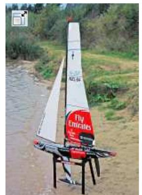
Die lange, achterlich abgeflachte Bleibombe erinnert an die Silhouette eines Haifisches. Unterstützt wird das Bild durch zwei seitlich abgespreizte Finnen am konischen Ende der Ballastbombe. Schon beim Bau ahnte ich, dass die ganze Apparatur schnell Freundschaft mit den Wasserpflanzen schließen würde. Ohne Kommentierung in der Bedienungsanleitung liegt dem Baukasten insoweit eine schlichte Plastikabdeckung als Bau-Alternative bei.
