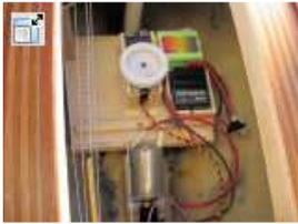
Die ges. Technik habe ich auf ein Sperrholzbrett aufgebaut, damit man bei Einstell- und Wartungsarbeiten die ges. Elektronik aus dem Schiffsinern entnehmen kann.
