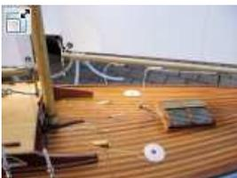
Die Aufbauten bestehen aus dünnem Sperrholz belegt mit Mahagoni Fournier und zum leichteren Zugang zu den Elektronikbauteile (Segelwinde- Servo Motor) abnehmbar gebaut.
