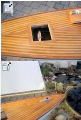
Der nächste Arbeitsschritt ist das Vorbereiten zur ersten Belegung mit dünnem Flugzeug Sperrholz für die spätere Deckbelegung mit Red Zeder Leisten hell und dunkel und einer Mahagoni Königsleiste. Die Deckleisten habe ich mit Ponal blau (wasserfest) auf dem Sperrholzdeck verlegt und anschließend mehrmals geschliffen. Nach dem der Rumpf fertig war, habe ich das Deck mit einem Klarlack matt 2-3 mal lackiert.
