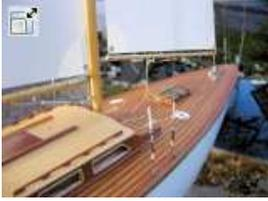
Wie Sie aus dem Foto ersehen können, habe ich eine kleine Luke auf das Vorschiff gesetzt. und eine U-Schiene aus dem Modellbau Zubehör zur Einstellung des Vorsegels. Auch die Wantenspanner (3,5mm Gewinde) sind aus dem Modellzubehör.
