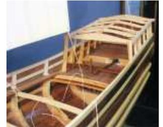
Der Kiel ist aus 15 x 40 mm Messing – 4800 g – und beidseitig mit 4 mm Eiche beplankt hergestellt. In das Messing werden 4 mm Löcher gebohrt und M 5-Gewinde geschnitten, innen zwischen den Spanten je 2 Stück, unten 6 Stück. Diese Gewinde sind innen zur Befestigung der Segelmechanik, Mastkoker und Flautenschieber usw. und unter dem Kiel für Ballast gedacht. Der Kiel wird von unten durch das Hellingbrett mit M 5 Schrauben fixiert.
