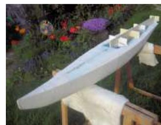
Nun überzog ich den ganzen Rumpfkern mit einer Lage Glas 160g/m<sup>2</sup> Körper wurde der Rumpfkern verfestigt. Darauf eine Lage Abreissgewebe 100g/m<sup>2</sup> Körper. Nach dem entfernen des Abreissgewebes nochmals spachteln und schleifen. Dann habe ich den Rumpfkern mit Trennwachs (6 Lagen) auf das laminieren vorbereitet. Das Glasgewebe und die Carbonmatten wurden in gewünschter
