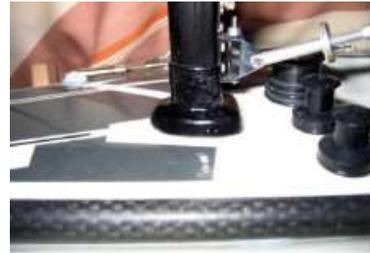
In den Rahmen baute ich gleich auch 2 Serviceöffnungen ein, um an die Ruderanlenkung mit Servohalterung zu gelangen, und vorne für Akkuwechsel und arbeiten an den RC-Komponenten. In die Rahmen passte ich wiederum kleinste Supermagnete ein, welche dann die am Deckel aufgeklebte Metallfolie als Gegenstück anzieht und das Deck somit verschliesst. Als Dichtmasse verwendete ich schwarze Silikondichtung aus der Autobranche, die dichtet gut ab.
