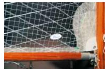
Abb.10 Das Großsegel aus 40g-Mylar wird an Mast und Baum in der Keep geführt
