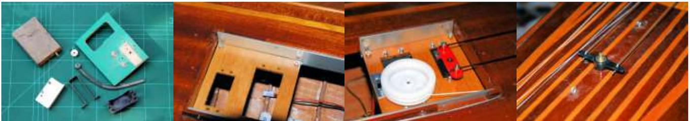
Nachdem der Schrott aus dem Rumpf entfernt war (Abb.3), wurde eine Servoplatte in die Luköffnung eingepasst (Abb. 4 und 5). Der Empfängerakku findet tief unten im Rumpf seinen Platz (Abb 4.). Das Rudergestänge verläuft dagegen an Deck (Abb.6).
