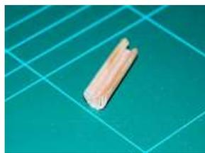
Abb. 8 und 9 Der Fockbaum (Abb.9) ist aus 4 Einzelleisten verleimt, deren innere Ecke abgehobelt wurde bei Zusammenleimen entsteht so die Keep im Inneren des Baumes (Abb.8).
