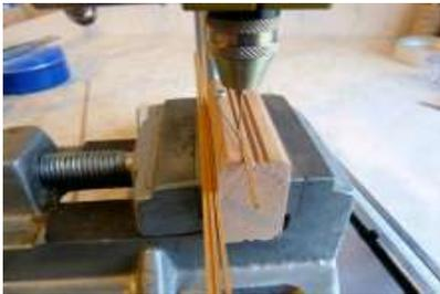
Bohren der Blockleisten nach dem Fräsen
